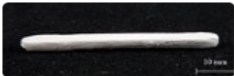
Образцы BaTiO 3 , напечатанные на экспериментальной SLA установке с 465 нм лазером
