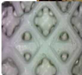
Образцы BaTiO 3 , напечатанные на экспериментальной SLA установке с 465 нм лазером
